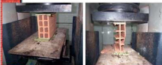
Mise en place sur la presse
